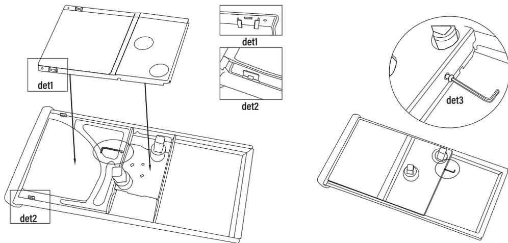
**Passo 03: a)** Fixar o suporte do assento (item 03) à madeira do assento (item 05) com 6 parafusos (item b). **b)** Virar o conjunto montado no passo (a), para que o suporte fixado permaneça para baixo, em seguida colar a madeira do assento. Após unir o conjunto, tapeçar o assento.
