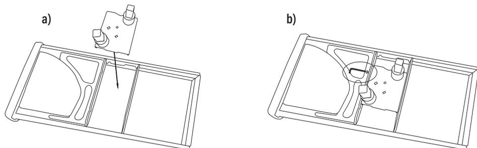
**Passo 02:** Encaixar a tampa LD (item 02) sobre a lateral LD (item 01), (**det.1** encaixa-se sobre **det.2**). Parafusar pelo lado inferior, a tampa na lateral e no mecanismo (**det.3**) com 1 parafuso (item a), conforme ilustrado. Proceder da mesma forma para o LE.
