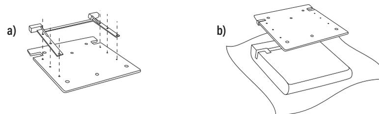
**Passo 04: a)** Fixar o suporte do encosto (item 04) à madeira do encosto (item 06) com 6 parafusos (item b). **b)** Virar o conjunto montado no passo (a), para que o suporte permaneça do lado oposto, em seguida colar na espuma do encosto. Após unir o conjunto, tapeçar o encosto.
