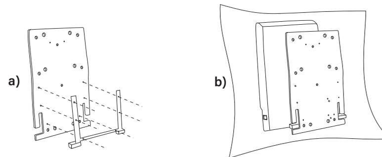
**Passo 05: a)** Encaixar o conjunto de encosto (montado no passo 04), no encaixe inferior do mecanismo da lateral esquerda, montado no passo 02. Apertar o parafuso (item d) na parte posterior do encosto **det1**. **b)** Encaixar o conjunto do assento (montado no passo 03), no suporte superior da lateral esquerda. Apertar o parafuso (item c) do suporte na parte inferior do assento **det2**. **c)** Repetir os passos a e b para a lateral direita.
